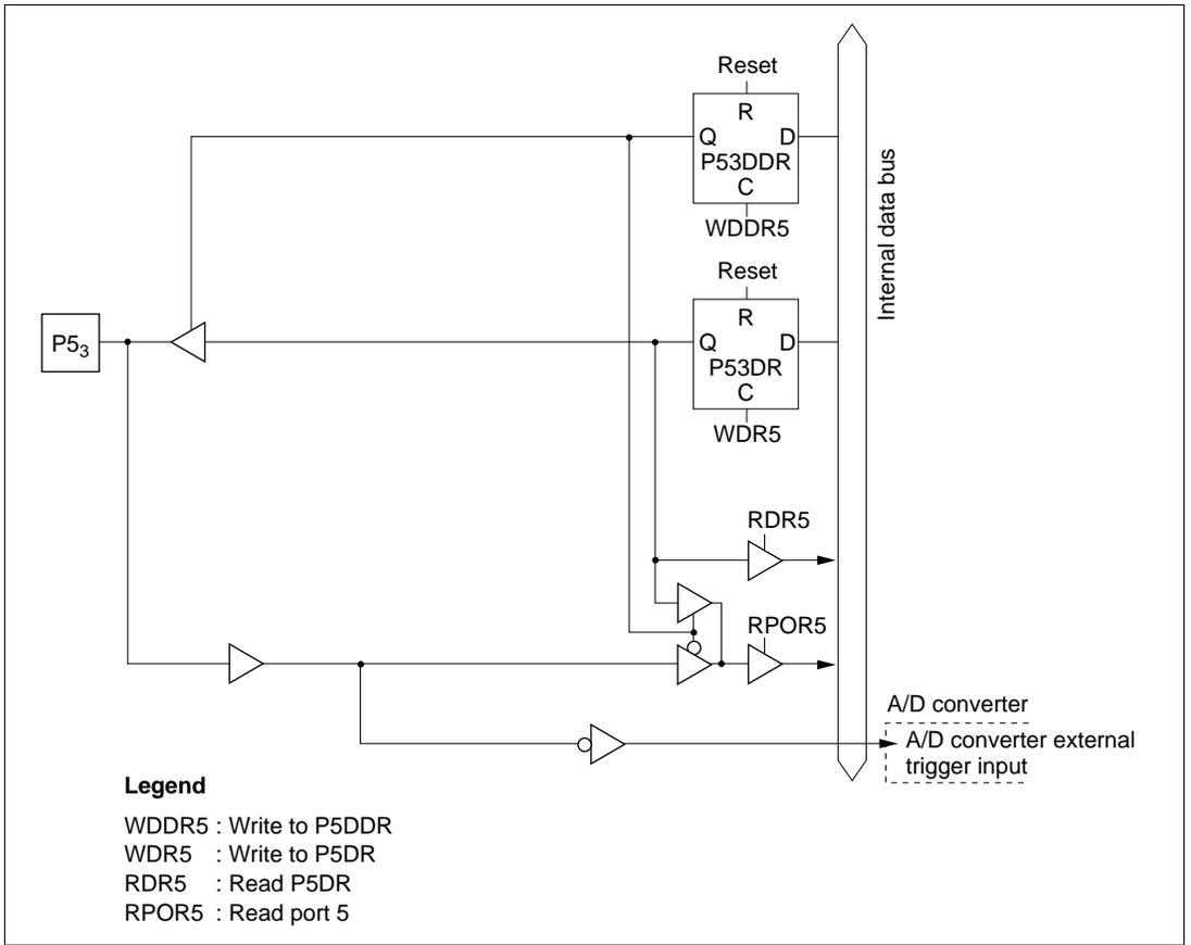
Figure C-5 (d) Port 5 Block Diagram (Pin P5<sub>3</sub>)
