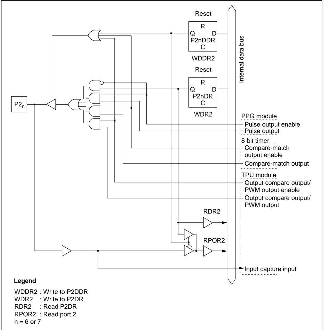
Figure C-2 (d) Port 2 Block Diagram (Pins P2<sub>6</sub> and P2<sub>7</sub>)
