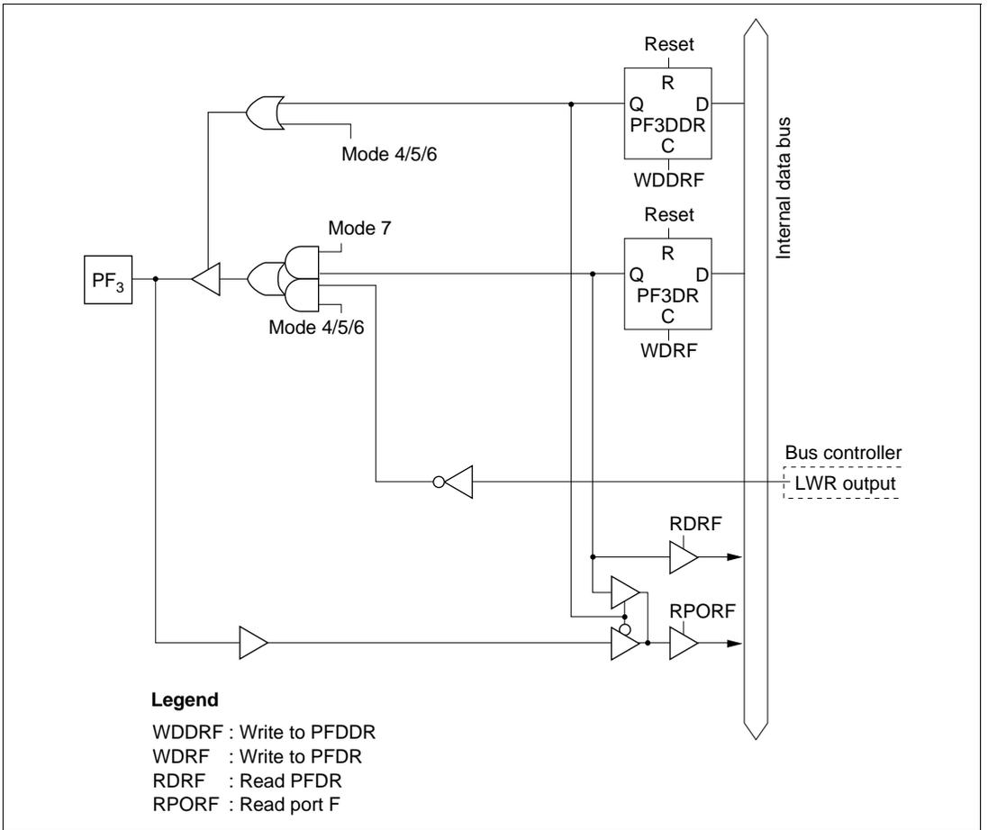
**Figure C-12 (d) Port F Block Diagram (Pin PF<sub>3</sub>)**
